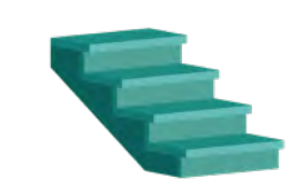
aufgesättelt mit den Setzstufen mit der Wassernase
