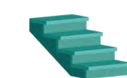
nakładane z podstopnicami z noskiem (kampinosem)
